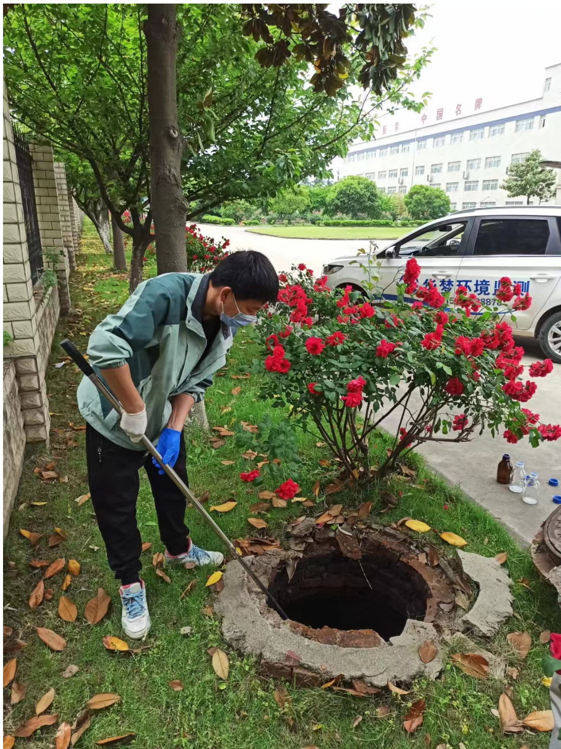
污水排污口监测取样
