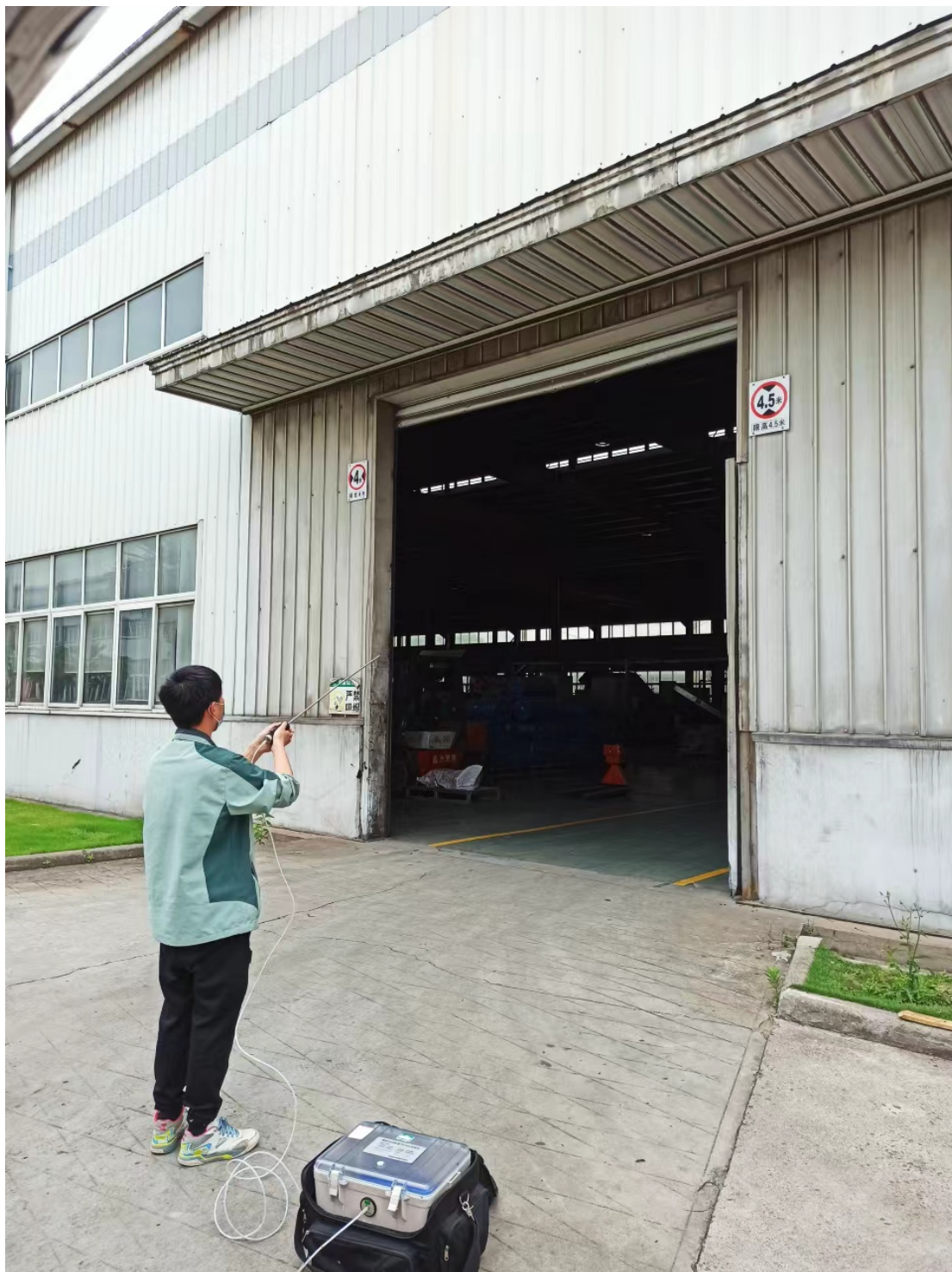
厂内废气监测取样 1
